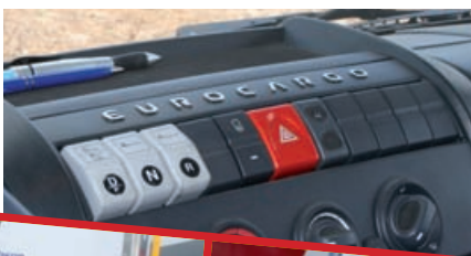
A la izquierda, controles del cambio Allison. Abajo, la única operación manual que se efectúa es el cambio de las conexiones eléctricas; el antiempotramiento se pliega automáticamente; carga de la segunda caja; y el sistema de puertas que permite cargar las dos cajas a la vez.
